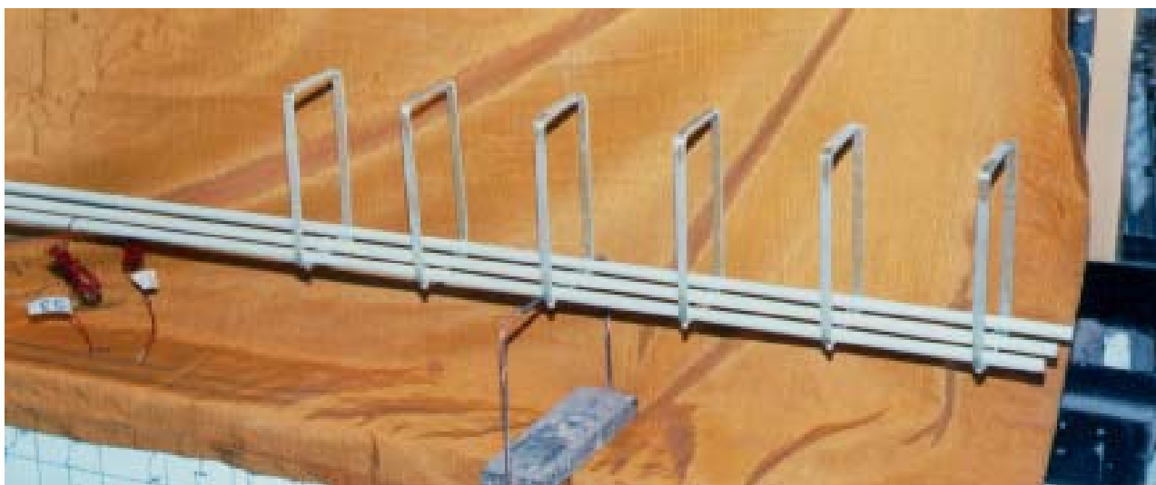
Slika 1 - Plastična FRP armatura za grede GB5, GB6, GB9, i GB10
