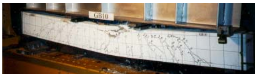
Slika 4. Lom grede savijanjem sa odgovarajućim dijagramom napadna sila - ugib grede
